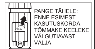
Joonis 2: välguti patareipesa
