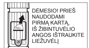
2 pav.: žibintuvėlio baterijų lizdas
